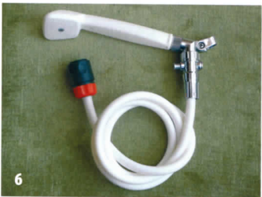
► Les mêmes éléments, vissés entre eux. La douchette est prête à être raccordée au tuyau d'arrosage.
