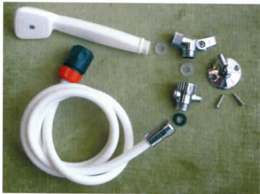
► L'ensemble des éléments de la douche : douchette (à économie d'eau), bride articulée et son support piton, stop-douche à poussoir, flexible équipé du raccord rapide, joints en caoutchouc.
