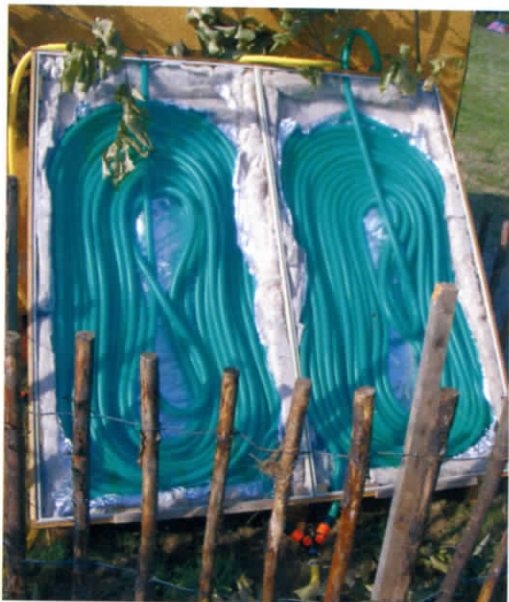
► Les deux capteurs sont isolés à la laine de mouton et couverts d'un film plastique. Une feuille d'aluminium renvoie les infrarouges. En bas, un sélecteur à deux directions distribue l'arrivée d'eau froide aux deux capteurs.
